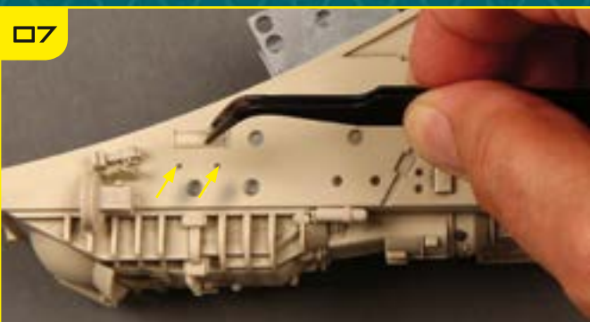
07 Вклейте два штифта детали 6 в отмеченные стрелками отверстия в «жвале».
